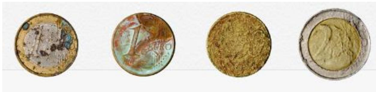
3. **Dommmages mécaniques** : Pièces endommagées par des processus mécaniques ou des actions délibérées qui entraînent des modifications importantes de la forme, de la taille ou d'autres spécifications techniques d'origine de la pièce. L'emplacement ou la dimension du dommage mécanique n'est pas pertinent dans cette caractéristique, ainsi toute pièce présentant cette caractéristique doit être retirée de la circulation.
